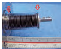
ベローズ溶接
